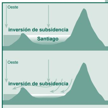
Figura 3. Diagrama de inversión térmica de altura de Santiago.
